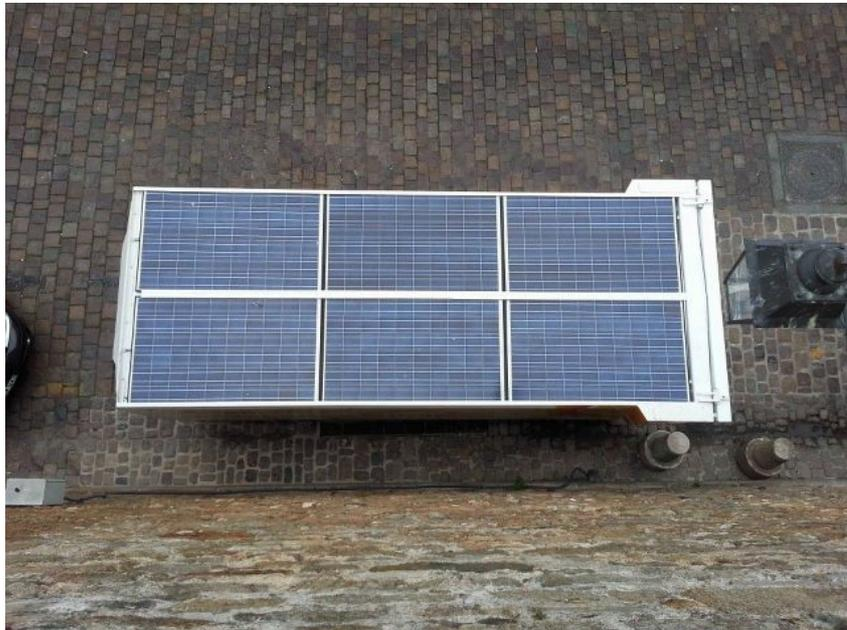
**Panneaux solaires sur le toit du compacteur**
