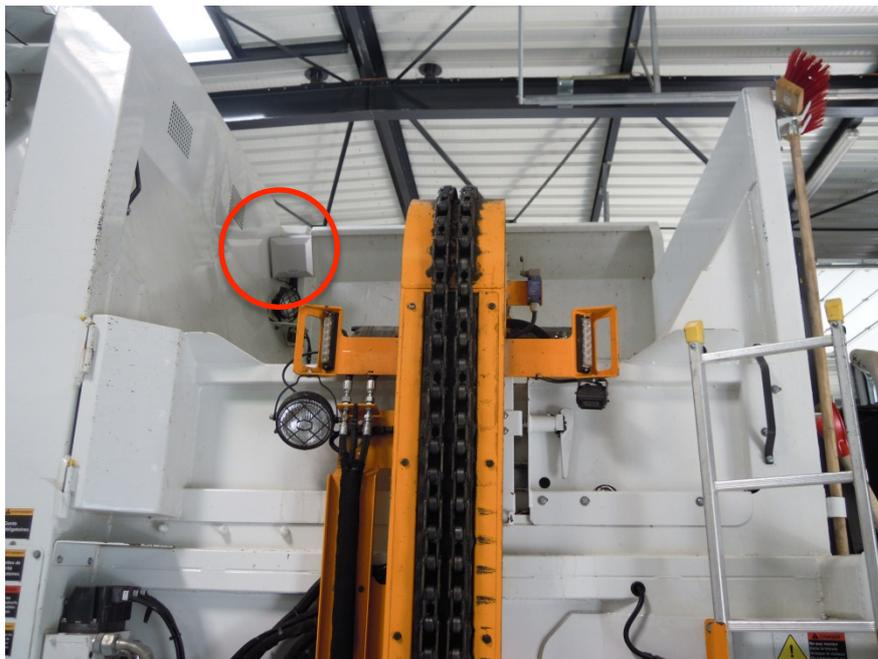
**Antenne de détection des puces UHF**
