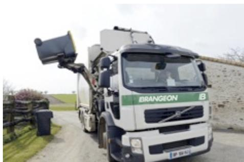
3 BOM SEMAT robotisées de PTAC 26 tonnes à chargement latéral des bacs (préhension de type double peigne et pince, ouverte par le chauffeur si le bac est mal positionné) ont été achetées (cf. image ci-contre), qui permettent de réduire l'équipage à un seul agent de collecte par camion lors des tournées de collecte et donc de maîtriser les coûts.
