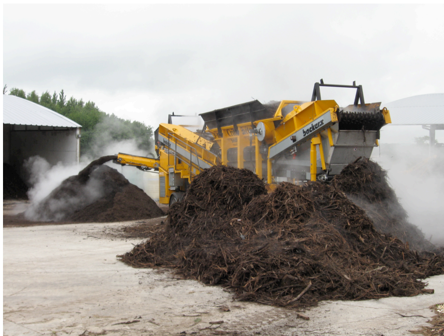
Criblage du compost
