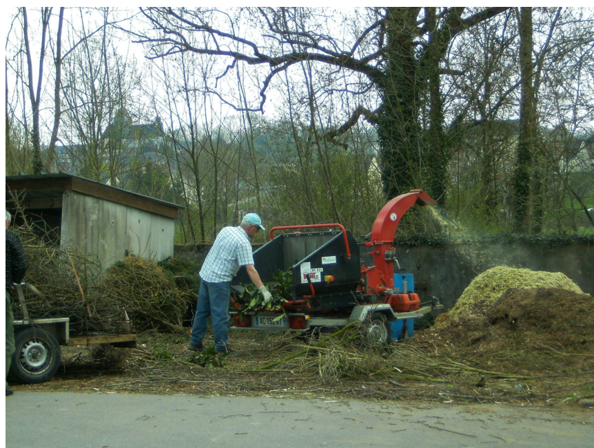
Broyage des déchets verts ligneux
