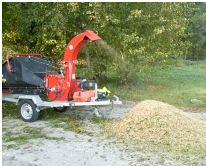
Broyeur utilisé pour le broyage de la fraction ligneuse des déchets verts
