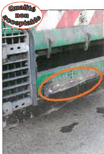
L'appui bas a totalement disparu
