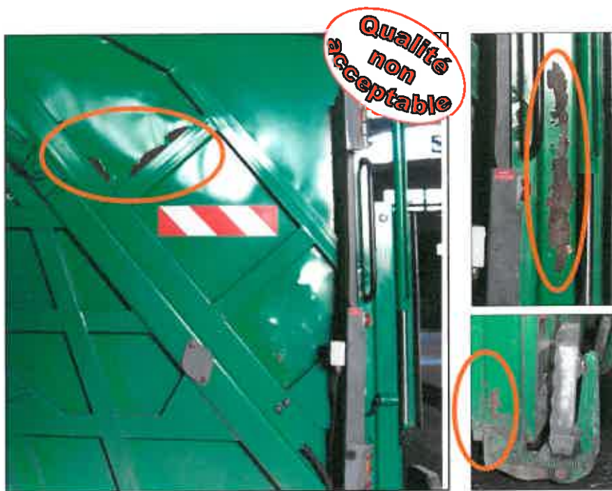
Le véhicule présente des amorces de rouilles
