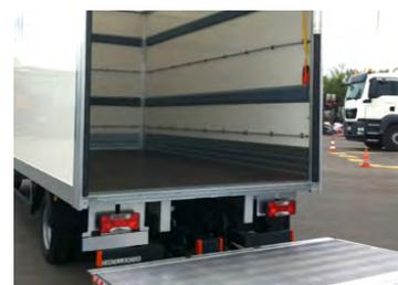
*Camion de 3,5 tonnes, 20m<sup>3</sup> avec hayon utilisé lors de la collecte*
