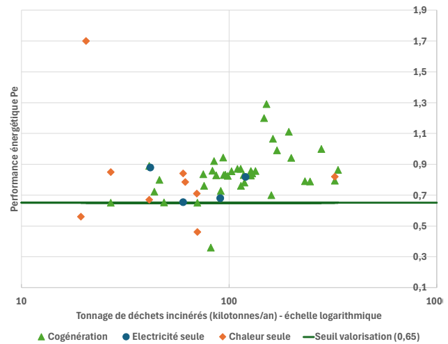
Figure 17 : Performance énergétique ( Pe ) en fonction du tonnage de déchets incinérés (échantillon : 52 réponses)
