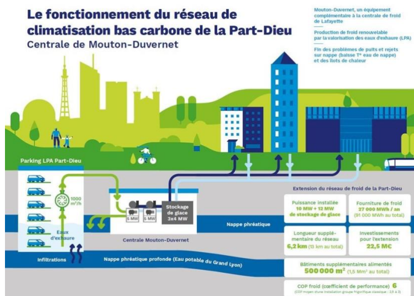
Figure 18 : Principe de fonctionnement du réseau de froid de la Part-Dieu - Métropole de Lyon
