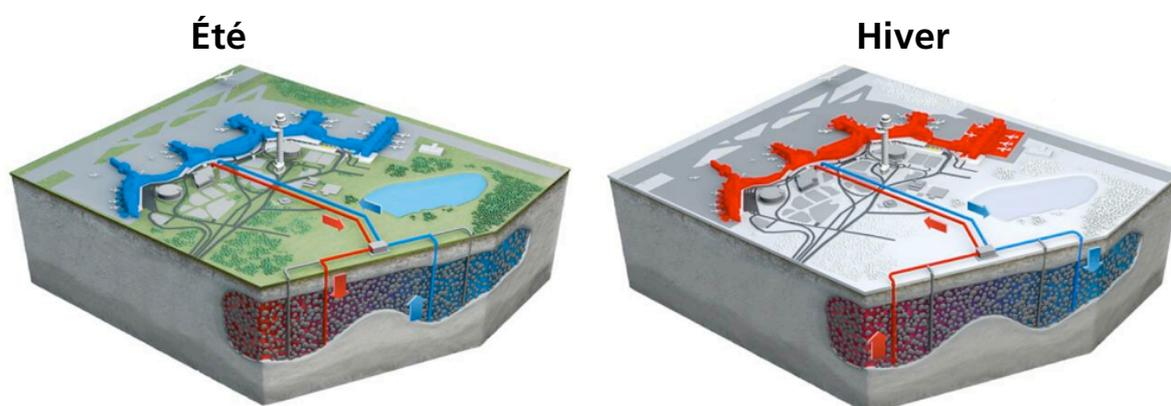
Figure 12: Schéma illustratif d'un stockage en aquifère (source: Underground Energy, LLC)
