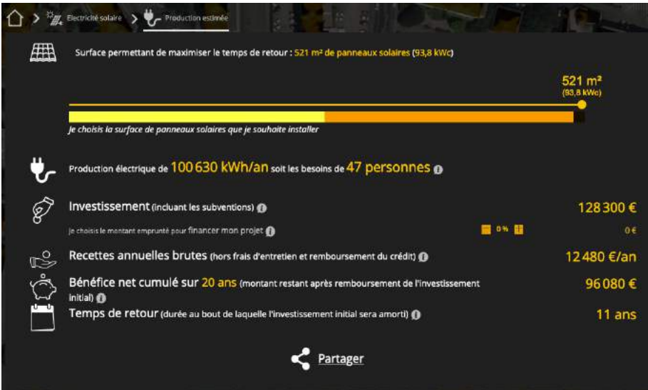
fig 38. Simulation de la production d'une toiture sur l'outil Métrosoleil de la Métropole de Grenoble
