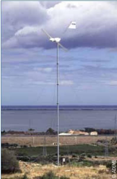
Figure 9 : Petite éolienne de 12m de hauteur, puissance de 2,4 kW
