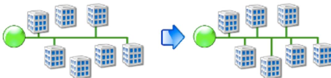
Figure 2 - Schéma de principe de la densification : des antennes sont créées le long du réseau pour raccorder les bâtiments à proximité. Source : CEREMA
