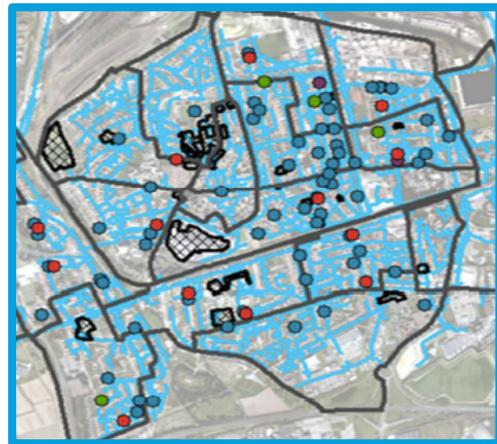
Figure 4: Localisation des opérations Reflexénergie et lien avec le réseau de gaz naturel (bleu : isolation des combles, rouge : chaudière condensation, vert : isolation des murs, violet : isolation terrasse)
