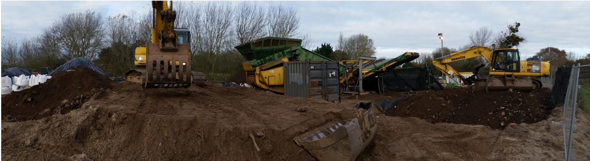
Photo de la chaîne de tri avec la séparation des trois fractions (>100mm, 6 à 100mm, < 6mm)
