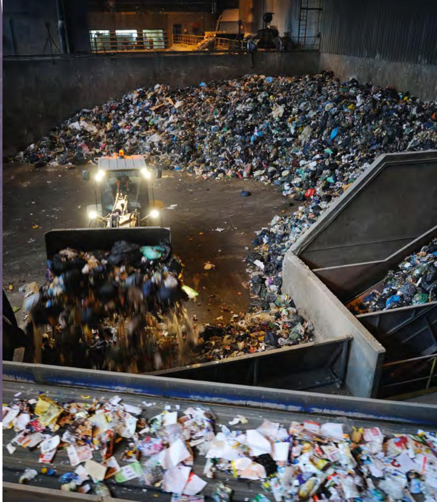
Fig. 1. Remplissage d'une trémie à partir de déchets entreposés à l'abri de l'humidité.
