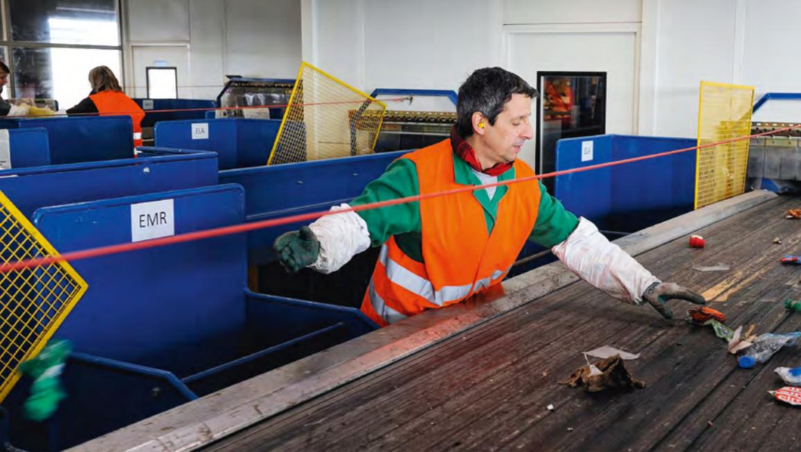
Fig. 2. Cordon d'arrêt d'urgence du tapis de tri.
