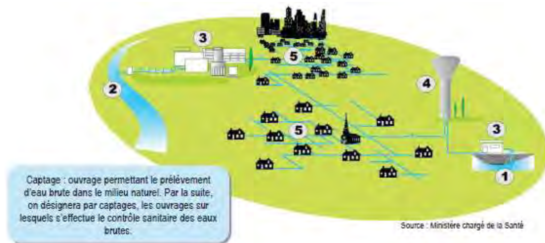
Graphique 13 : Représentation des différentes installations nécessaires à la fourniture de l'eau
