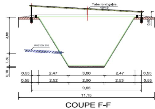
Il est dimensionné (pour les dimensions cf. plan) pour contenir toutes les eaux drainées à l'intérieur des fosses. Un grillage est placé à l'entrée de chaque tuyau d'évacuation du lixiviat pour empêcher l'entrée du gravier dans la canalisation. Afin d'accélérer l'évaporation rapide des lixiviats, il est disposé au-dessus du bassin un hangar avec de la tôle noire qui sert aussi à empêcher les eaux de pluie de tomber directement dans le bassin de décantation.
