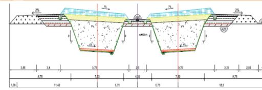
La couverture définitive doit permettre un ruissellement maximum, grâce à une pente suffisante (14-15% prévu sur le plan), et devra avoir une épaisseur suffisante pour éviter toute infiltration. Elle sera enfin végétalisée avec des plantes pour éviter l'érosion.
