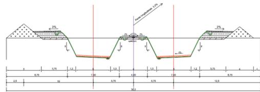
pour assurer l'étanchéité, protéger contre les éboulements et limiter l'infiltration latérale durant l'exploitation de l'alvéole.
