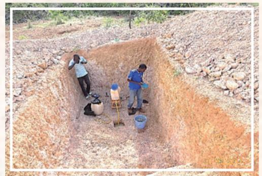
PHOTO 2 : Réalisation test de perméabilité lors de l'étude pédologique pour la réalisation de la décharge à PO
