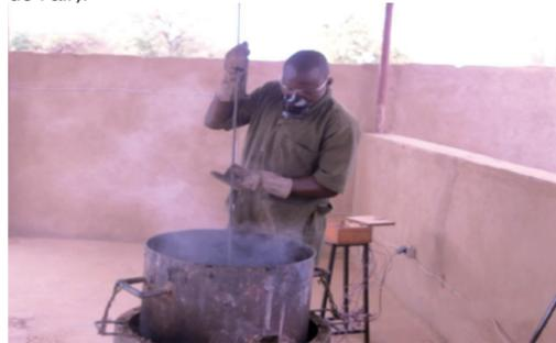
Figure 3 : Système artisanal de l'opération de fonte
