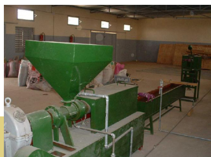
Illustration 2: Ligne d'extrusion d'un capacité d'une tonne/jour
