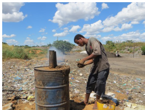
Illustration 5: Pyrolyseur de Madacompost
