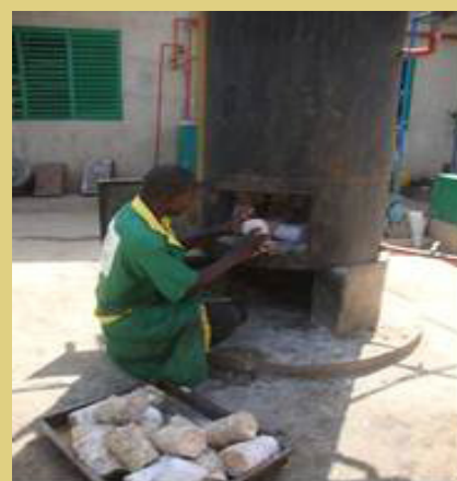
Illustration 4: Essais de combustion en chaudière industrielle
