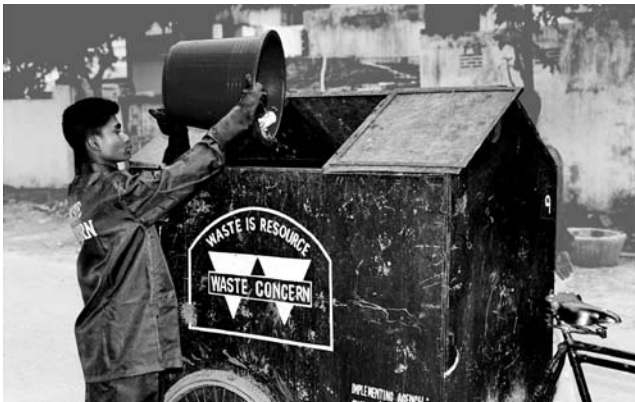
Photo 5.3 : Tricycle avec réservoir de collecte couvert muni d'une porte arrière (Waste Concern, Projet de collecte de déchets et de compostage, Mirpur, Dhaka, Bangladesh).
