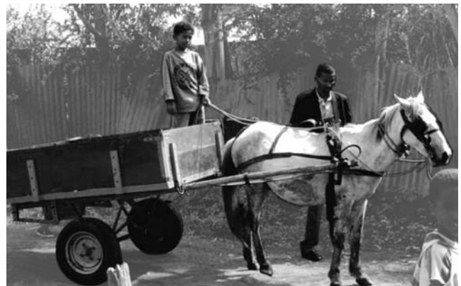
Photo 5.4 : Charrette à traction animale capable de tirer jusqu'à huit contenants rectangulaires (système d'échange de contenants) (Organisation communautaire, Agaki, Ethiopie).
