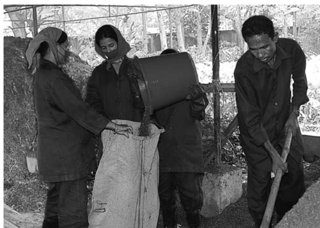
Photo 7.17 : Les sacs en polypropylène sont remplis de compost. Ils protègent le compost contre les précipitations abondantes mais permettent le passage de l'air. (Waste Concern, Bangladesh)
