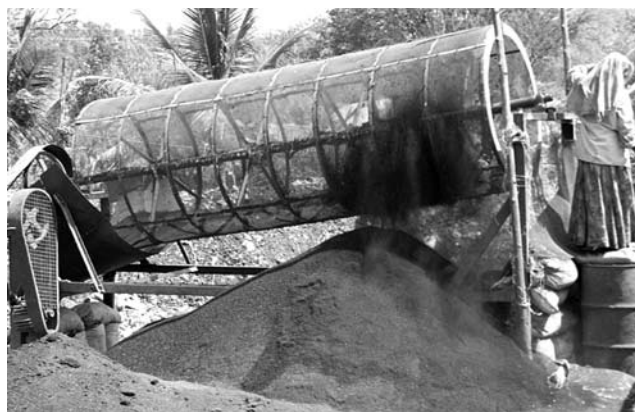
Photo 7.16 : Tamis rotatif à tambour à moteur pour de plus grandes quantités de compost (20 tonnes/jour). (Terra Firma, Inde)
