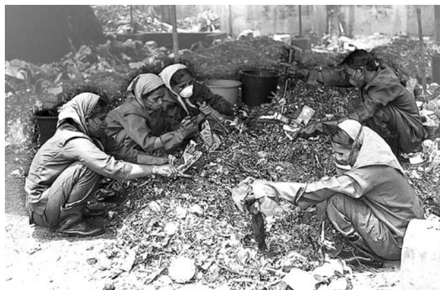
Photo 7.1 : Le tri des déchets domestiques mélangés entrants. En fonction des habitudes locales : certains préfèrent trier sur le sol, d'autres sur une table ou une plateforme. (Waste Concern, Bangladesh)
