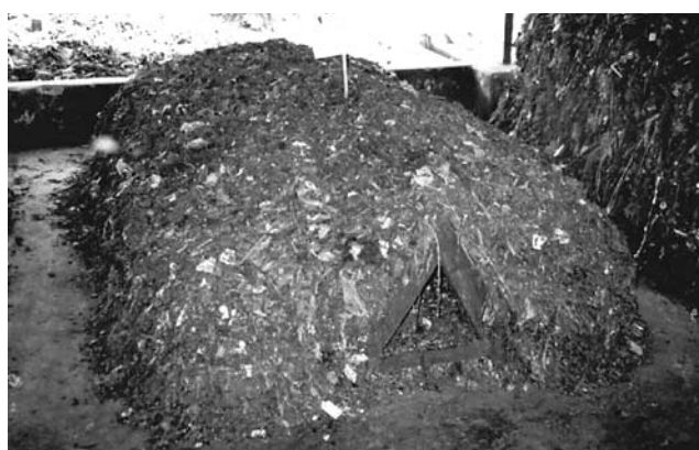
Photo 7.8 : Un andain après 40 jours de compostage et après être retourné à plusieurs reprises. La réduction de volume est évidente. (Waste Concern, Bangladesh)
