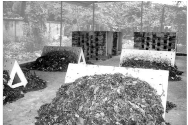
Photo 6.4 : Des déchets entassés autour de petits trous d'aération en plastique (Waste Concern, Bangladesh)
