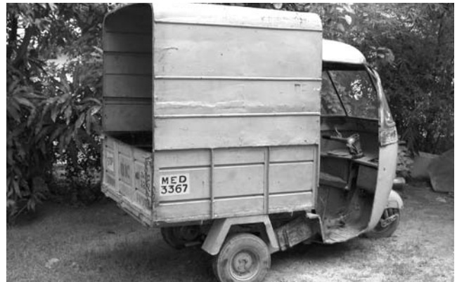
Photo 5.5 : Tree Pick-up affecté à la collecte de déchets sur de longues distances. La porte à rabattement arrière est souvent plus haute pour empêcher les déchets de se déverser (CEE Kalyan Nagar Residence Association, Bangalore, Inde).
