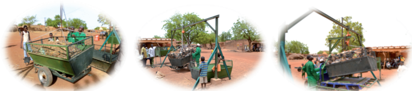
Photo 2,3,4 : éléments système charrettes benne triporteur version Palan
