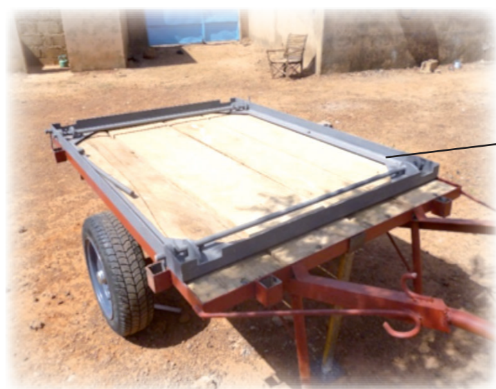
Photo 5 : charrette équipée du système à came
